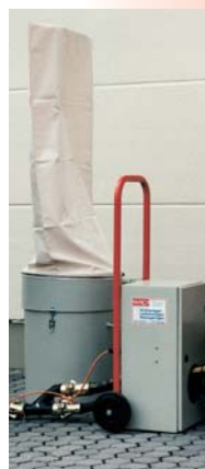
Bezpečnostná skriňa s rýchlym vypínaním Quick stop safety device with quick relief UVV VBG 48
